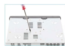
3. Însurubați HDD-ul până la capăt
